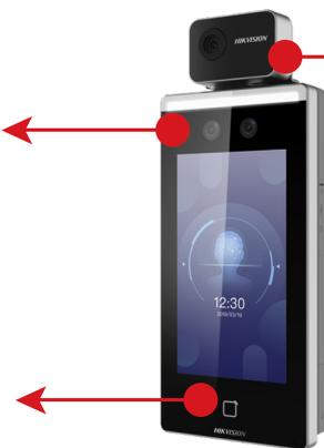
**Rilevazione della temperatura:** la presenza dell'ottica termografica grandangolo, unita all'intelligenza artificiale a bordo del dispositivo, garantiscono l'accurata ed immediata rilevazione della temperatura lungo l'intera superficie del display.
